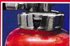
ふたが破損している
