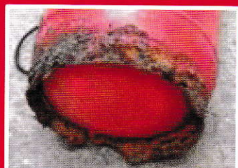
底部がさびている
